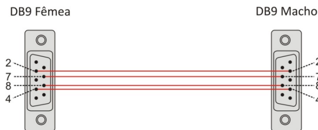
Fig. 26 – Confección del cable de extensión
