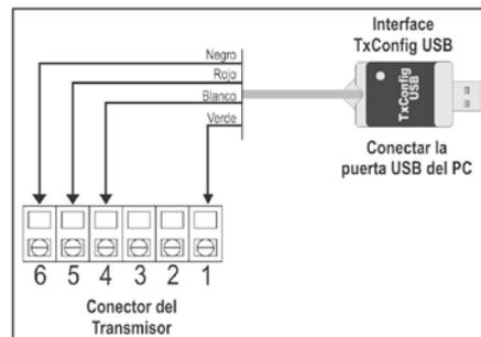
Fig. 03 - Conexiones de la Interface TxConfig USB
