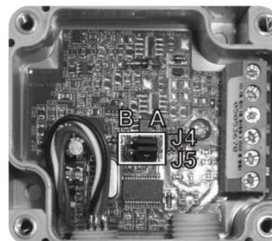
Fig. 09 - Localización de los Jumpers J4 y J5 en el interior del transmisor
