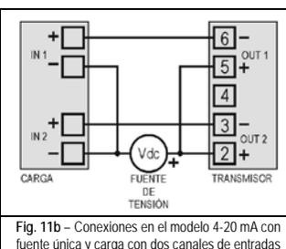
Fig. 11b - Conexiones en el modelo 4-20 mA con fuente única y carga con dos canales de entradas
