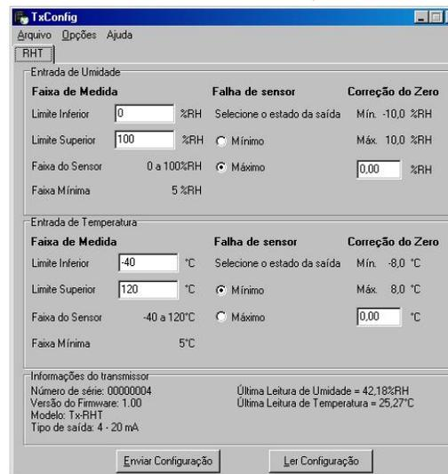
Fig. 04 - Pantalla principal del software TxConfig
