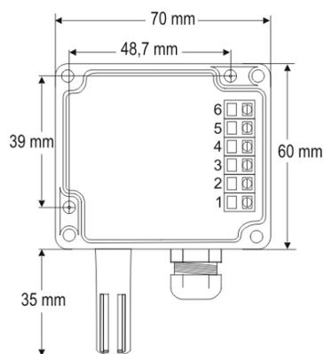
Fig. 08 - Agujeros de fijación y medidas do modelo RHT / WM.
