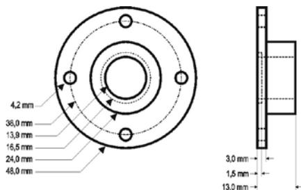
Fig. 06 - Brida para la fijación del modelo RHT/DM.
