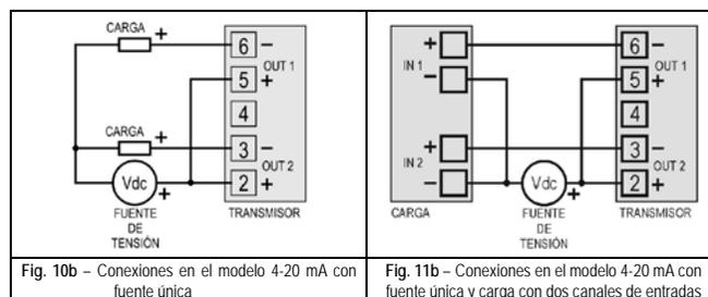
Fig. 10b - Conexiones en el modelo 4-20 mA con fuente única
