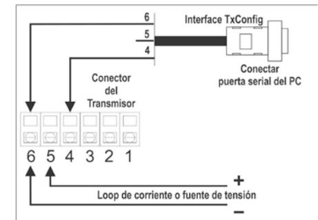
Fig. 05 - Conexiones de la Interface TxConfig - Alimentación por el loop
