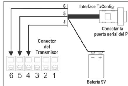
Fig. 02 - Conexiones de la Interface TxConfig modelo RS232
