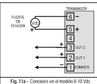
Fig. 11a - Conexões en el modelo 0-10 Vdc
