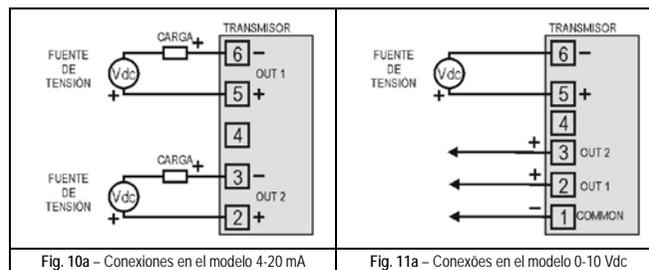
Fig. 10a - Conexiones en el modelo 4-20 mA
