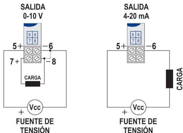
Fig. 12 – Conexiones eléctricas del transmisor (0-10 V y 4-20 mA)
