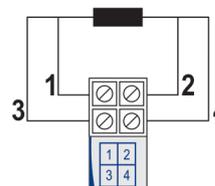
Fig. 9 – Conexiones eléctricas del transmisor (Pt100 4 hilos)
