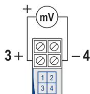
Fig. 11 – Conexiones eléctricas del transmisor (0-50 mV / 0-100 mV)
