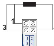
Fig. 8 – Conexiones eléctricas del transmisor (Pt100/Pt1000 3 hilos)
