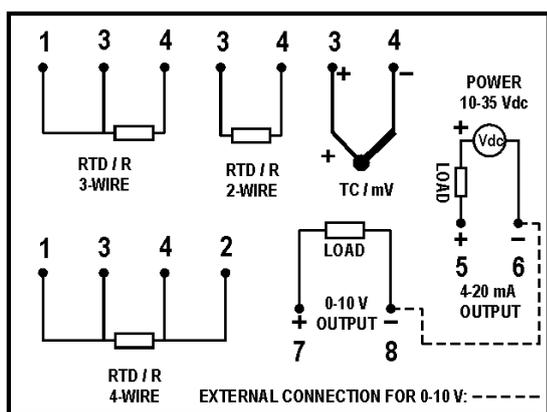
Fig. 6 – Conexiones eléctricas del transmisor TxRail-USB
