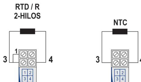
Fig. 7 – Conexiones eléctricas del transmisor (Pt100/Pt1000 2 hilos / NTC)
