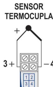
Fig. 10 – Conexiones eléctricas del transmisor (Termocupla)
