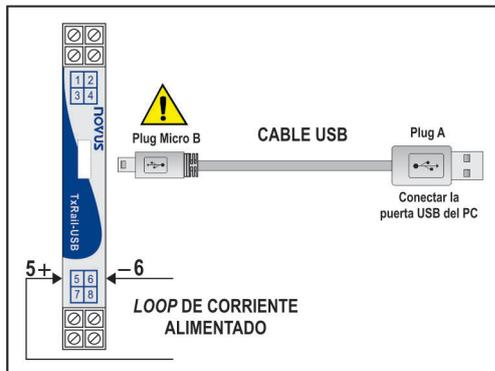
Fig. 2 – Conexiones del cable USB – Alimentación pelo *loop*
